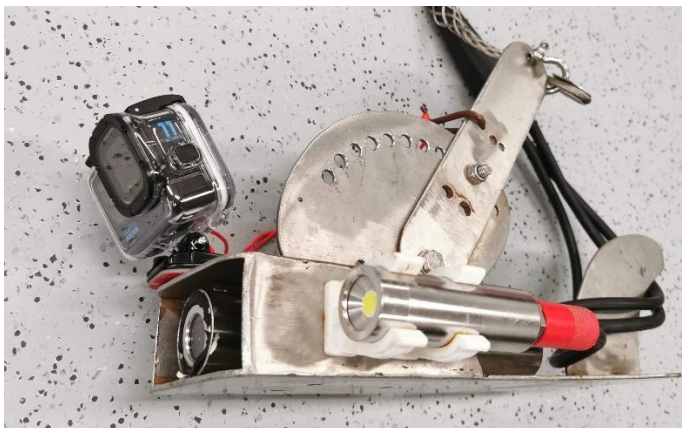
Joonis 3.1.3. GoPro kaamera kinnitatuna allveevideosüsteemi kaamera raami esiosa külge.
