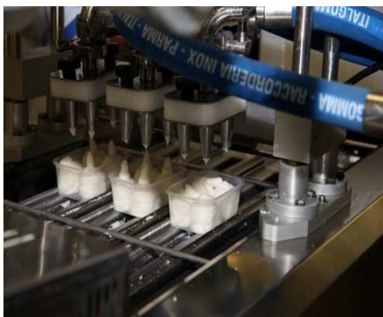
Piltidel on Põltsamaa Meierei Juustutööstuse Rannu tootmistehhi ricotta tootmisliin
